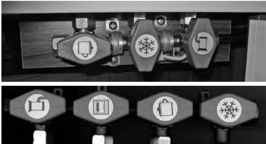
Heizung (Backofen * ) Gaskocher Kühlschrank
