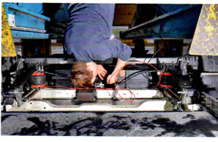
RAUS DAMIT Die Anschlagpuffer zwischen Karosserie und Blättdeder werden entfernt. Dazu muss der Aufbau per Wagenheber angehoben werden
