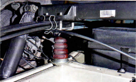
ANGERICHTET Neben Bälgen, Leitungen und Kompressor gibt es auch eine gute Einbauleitung
